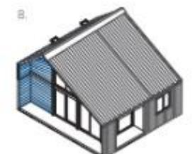
Instalar revestimiento singlado de madera en interiores terraza, cubierta y frontones.
