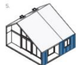
Instalar planchas de revestimiento de muros, según detalle de fijación XX. Instalar perfil cortagotera en encuentro de muro y techo
